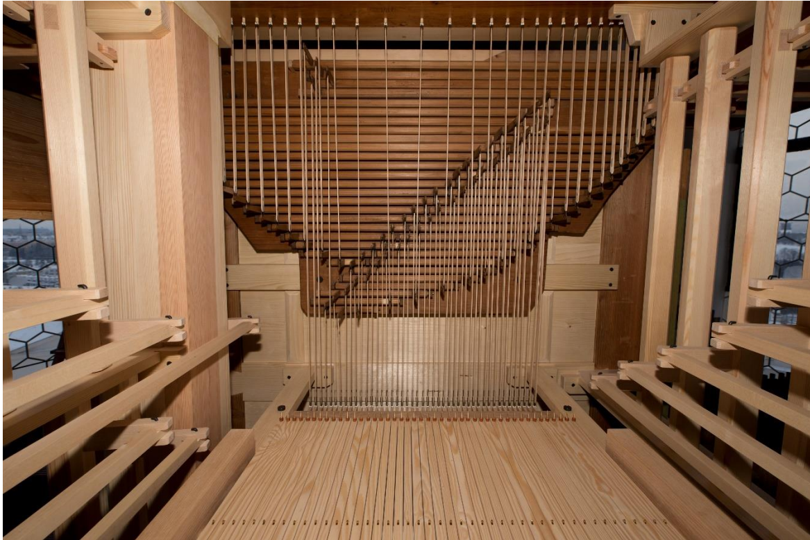
Obr. 4 Pohled do varhan na mechanickou trakturu [3].
