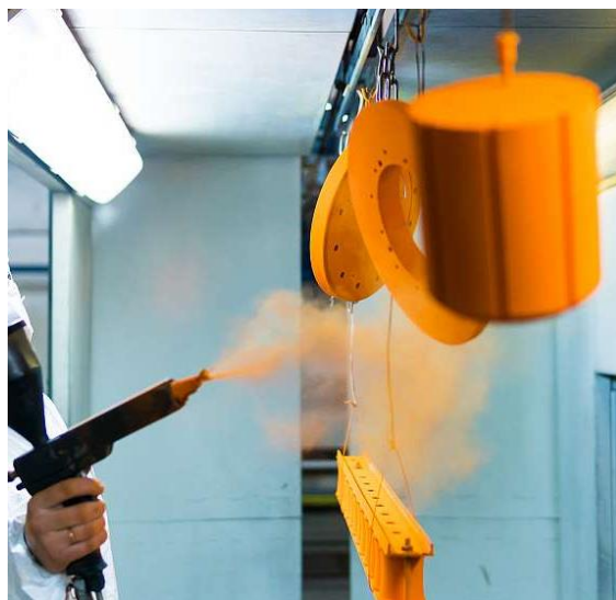
Obr. 31 Nanášení barvy stříkácí pistolí [24].
