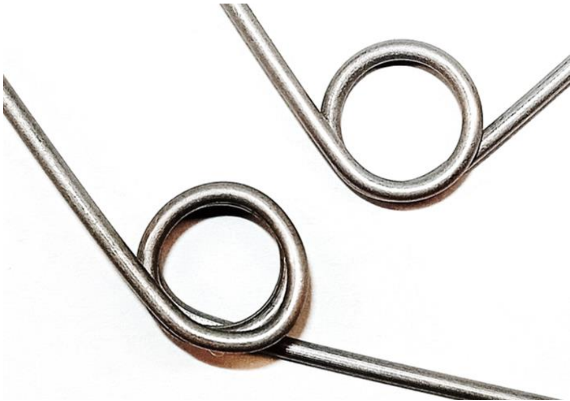
Obr. 51 Porovnání nově a původně vyrobeného závitu pružiny.
