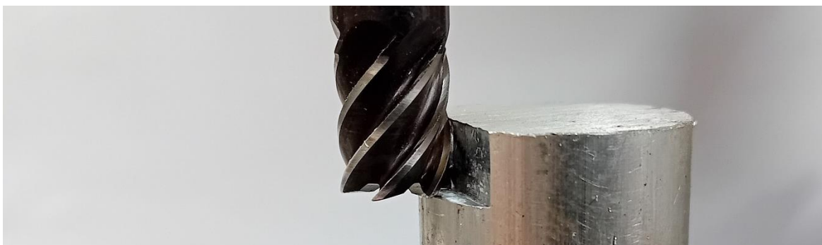
Obr. 18 Válcová čelní fréza se zuby ve šroubovici.
