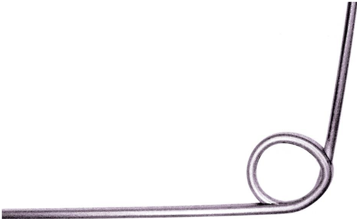
Obr. 11 Nedokonale vyrobený závit.
