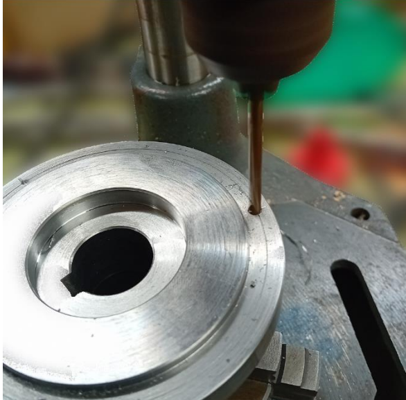
Obr. 24 Vrtání na stojanové vrtačce.
