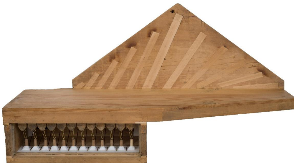
Obr. 5 Vzdušnice s otevřenou ventilovou komorou [3].
