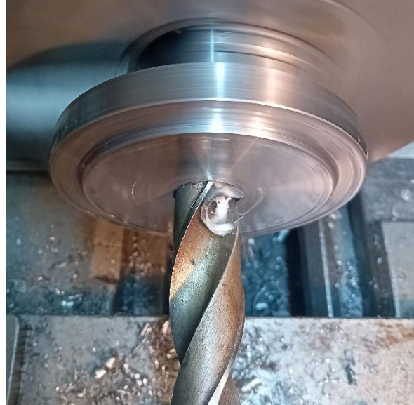
Obr. 25 Vrtání na soustruhu.
