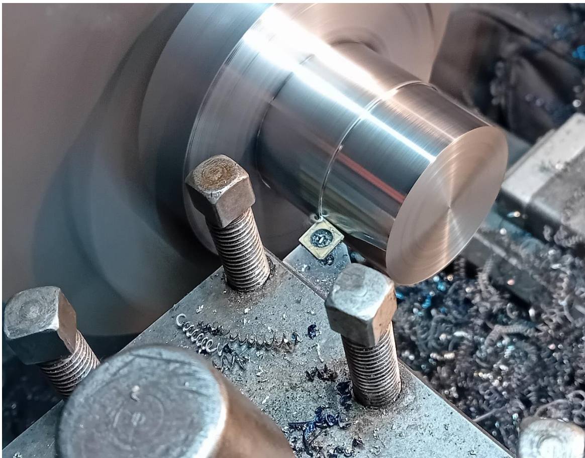
Obr. 22 Soustružení vnější válcové plochy.
