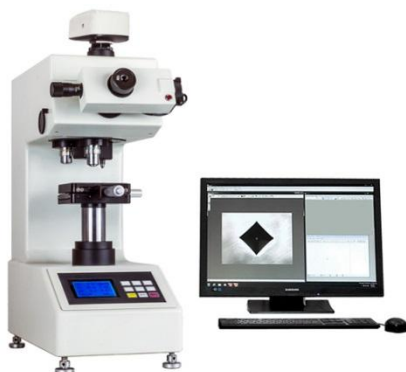
Obrázek 44 Mikrotvrdoměr DM2 Semi [30]
