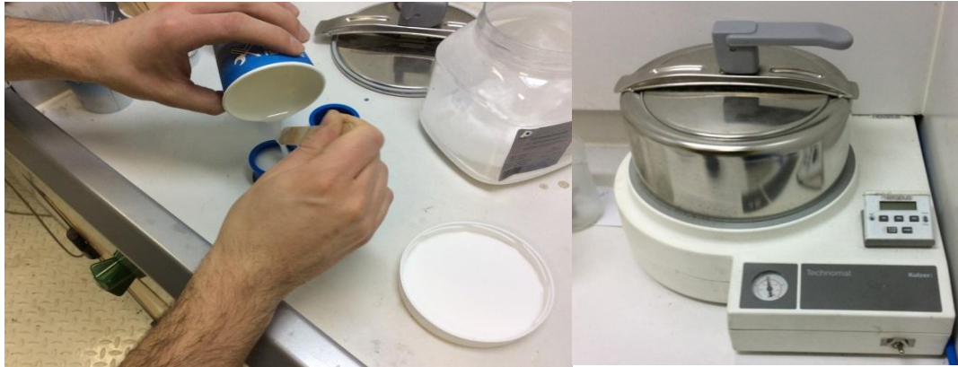
Obrázek 36 Zalévání jednotlivých vzorků a tlakový hrnec pro odstranění bublinek
