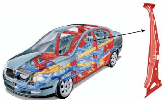
Obrázek 20 Použití 22MnB5 oceli při konstrukci karoserie [20]
