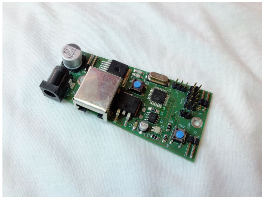
Obr. C.1: Fotografia plošného spoja servomechanizmu ventilu
