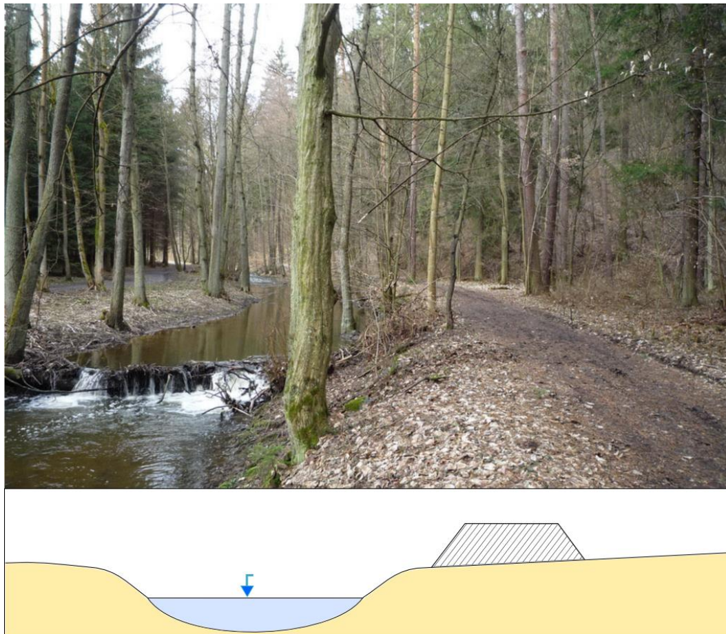
Obr. č. 29: Grafické znázornění návrhu ochranné hráze.
