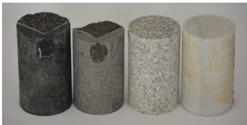
Obr. 3.23: Vzorky hornin použité pro přípravu inkluzí po lomových zkouškách (v pořadí zleva doprava): amfibolit, čedič, žula a mramor.
