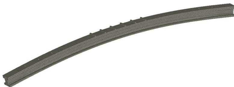
Obr. 4.61: Vzepětí nosníku od předpětí.
