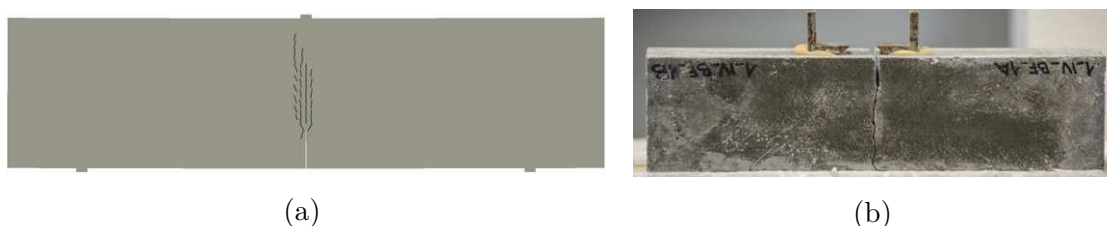
Obr. 4.55: (a) Vypočtený rozvoj trhlin v referenčním tělese, (b) sledovaný způsob porušení.
