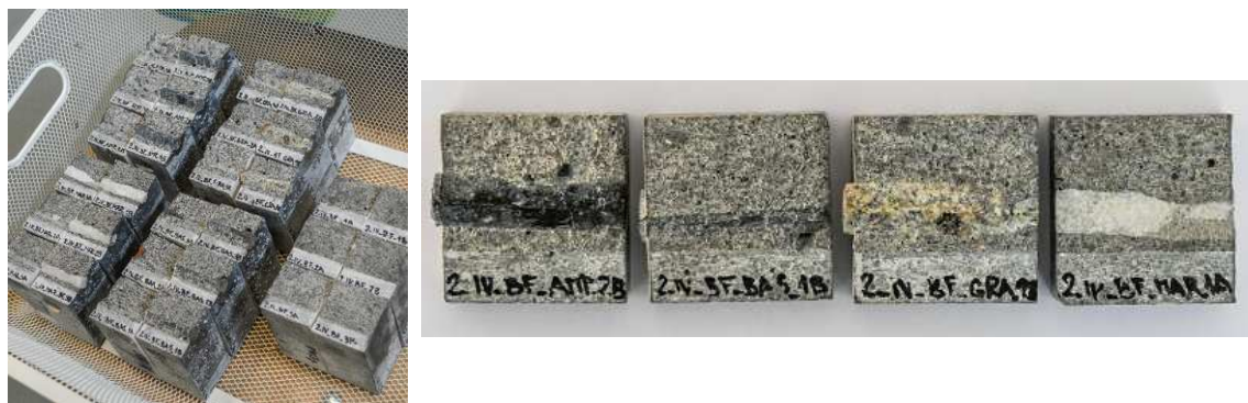
Obr. 3.11: Tělesa po lomové zkoušce (vlevo), vybrané detaily těles s inkluzemi: amfibolit, čedič, žula, mramor.
