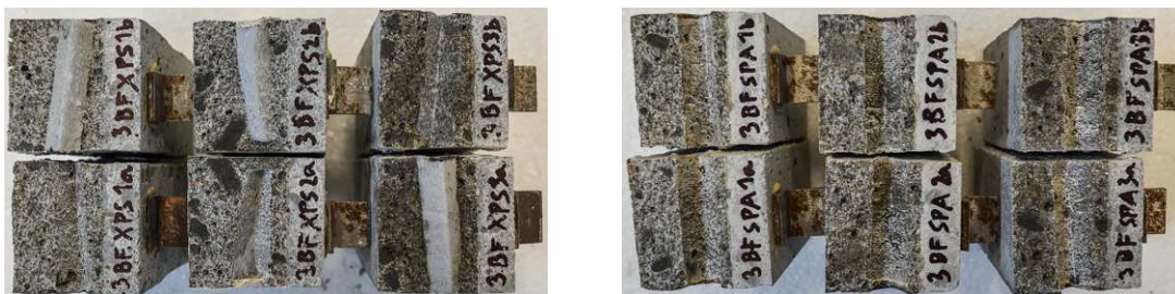
Obr. 3.13: Tělesa po lomové zkoušce těles s XPS inkluzí (vlevo) a těles s otvorem (SPA).
