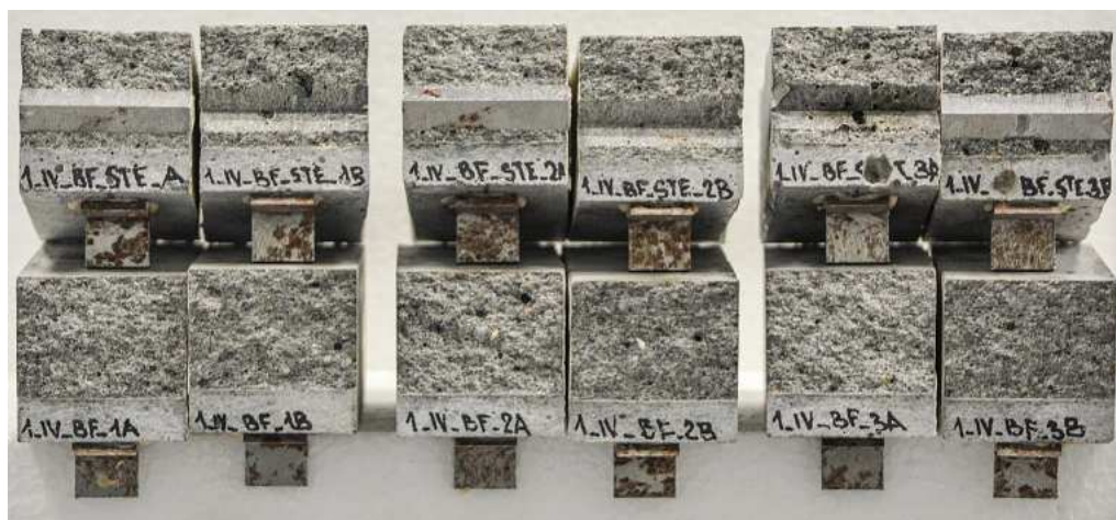
Obr. 3.9: Tělesa po lomových testech.
