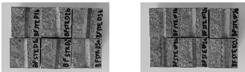
Obr. 3.16: Tělesa s ocelovou inkluzí po lomových zkouškách – zářez vytvořen diamantovým kotoučem (vlevo) a vodním paprskem (vpravo).
