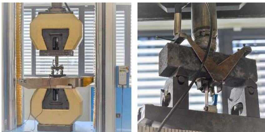
Obr. 3.5: Příklad zkoušky tříbodovým ohybem – mechanický lis LabTest 6-1000 (vlevo); detail měřícího zařízení.
