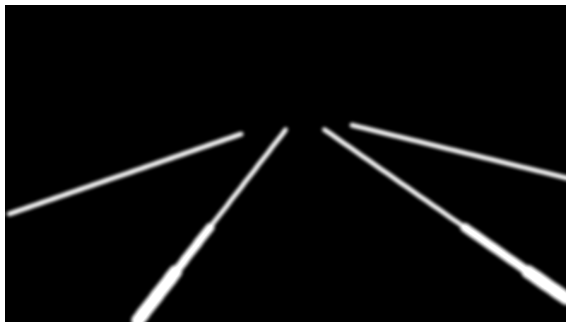
Obrázek 5.4: Ukázka masky, velikost 10, gaussovské rozostření s kernelem 17 a použití dynamické masky o velikosti 10. Silniční čára se zvětšuje o svoji velikost čím blíže je.
