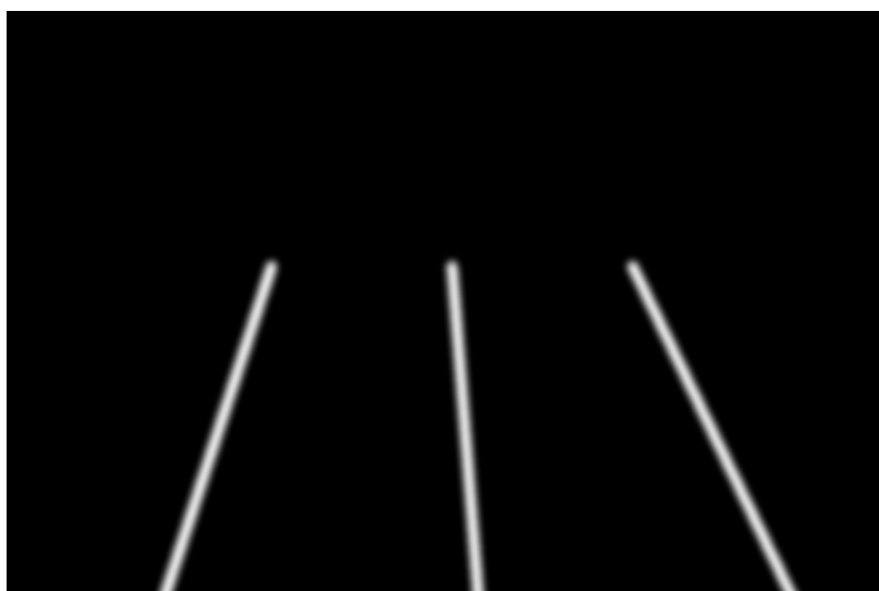
Obrázek 5.3: Ukázka rozostřené masky. Velikost silniční čáry je 10. Je použito Gaussovské rozostření s kernelem o velikosti 17.
