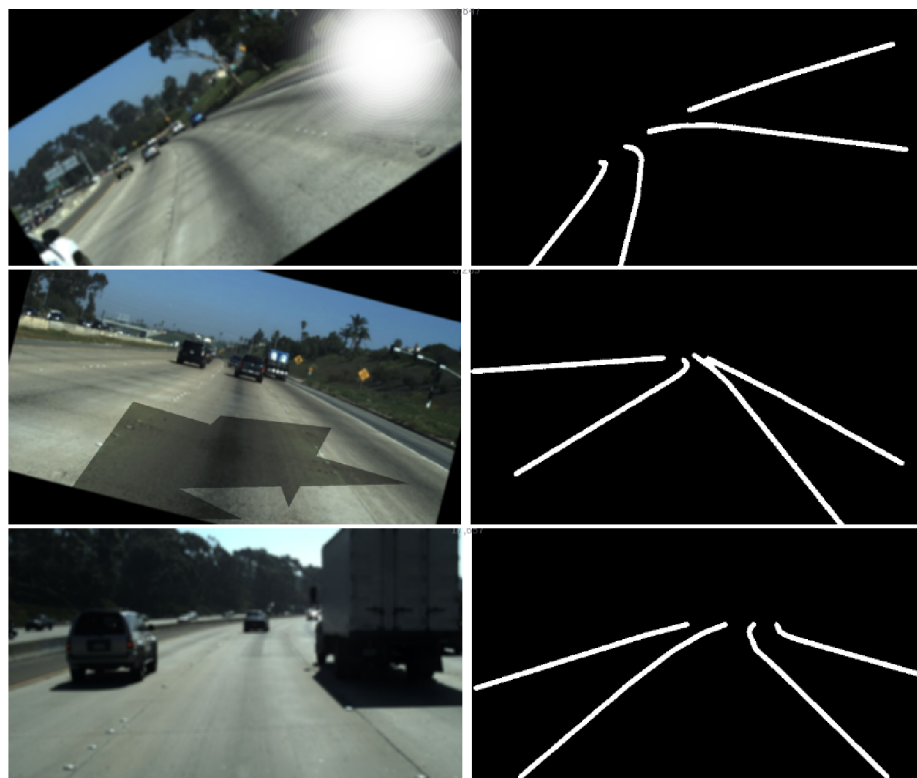
Obrázek 2.6: Ukázka augmentací použitých při trénování datasetu TuSimple (kapitola 5.2.1). Na prvním obázku je aplikována rotace na obrázek i jeho masku, a potom odraz slunce pouze na vstupní obrázek. Na druhé ukázce je rotace a náhodné stínování. Na třetím je pouze rozmazání, maska zůstala nezměněna
