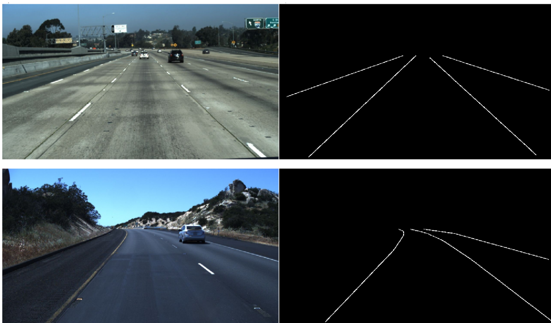
Obrázek 5.10: Přiřazené masky po konverzi. Anotace má přibližně 50 bodů, které konvertor spojí a přidá do černého obrazu jako bílou čáru s volitelnou velikostí (případně i s Gaussovým rozmazáním a dynamickou maskou)
