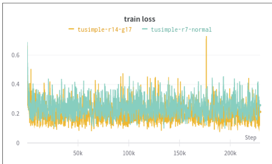
Obrázek 6.11: Trénovací chyba ukazuje hodnotu 0.285 ve finále pro normální běh (zelená) a hodnotu až 0.13 pro běh s Gaussově rozmazanou maskou (žlutá)
