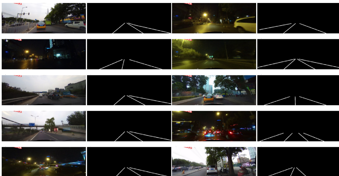
Obrázek 5.11: Ukázka obrázků a jejich konvertovaných masek připravené pro trénování z datové sady CuLane. Anotace jsou textového formátu. Jeden řádek v souboru obsahuje dvojice x – y souřadnic, který určují jednu silniční čáru v obraze – soubory obsahují většinou 3 až 4.
