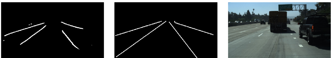
Obrázek 6.13: Ukázka výstupu neuronové sítě při učení nad datovou sadou TuSimple. Vlevo je maska predikovaná, uprostřed je maska opravdová, vpravo je vstupní originální obrázek.
