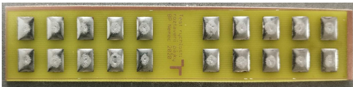
Obr. 3.2: Kupon s bezolovnatou trubičkovou pájkou Kester SAC305
