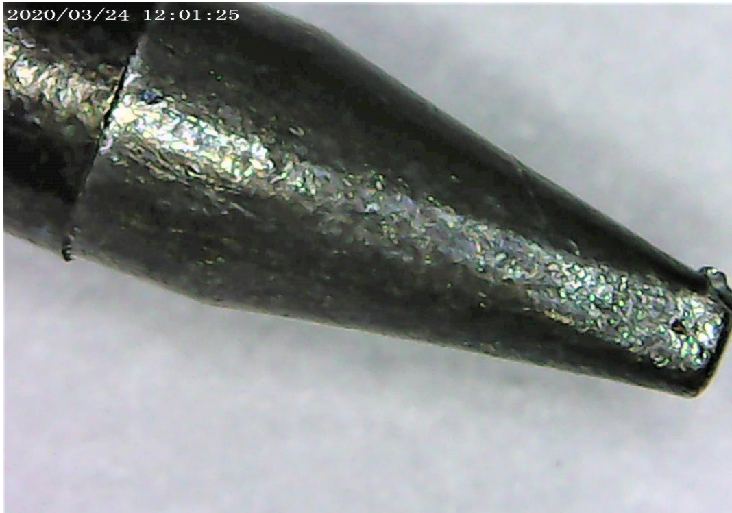
Obr. 3.28: Pájecí hrot po 2000 cyklech
