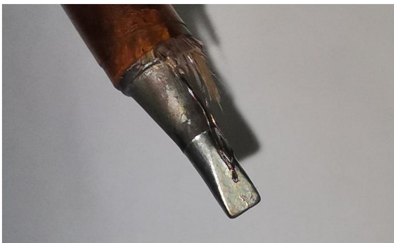
Obr. 3.4: Připevněný termočlánek na pájecím hrotu
