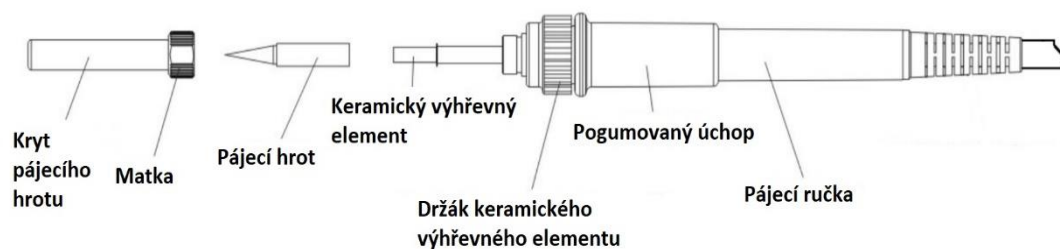
Obr. 2.5: Pájecí pero s odporovým výhřevným elementem (převzato z [16])
