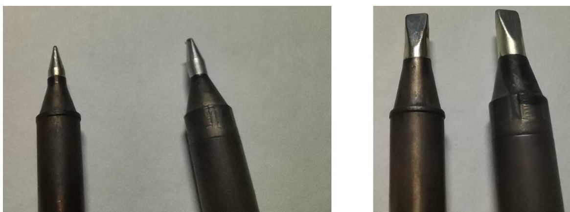
Obr. 3.5: Využité pájecí hroty během testů: T31-02D24 a T36-D08 (vlevo), T31-02D08 a T36-D24 (vpravo)
