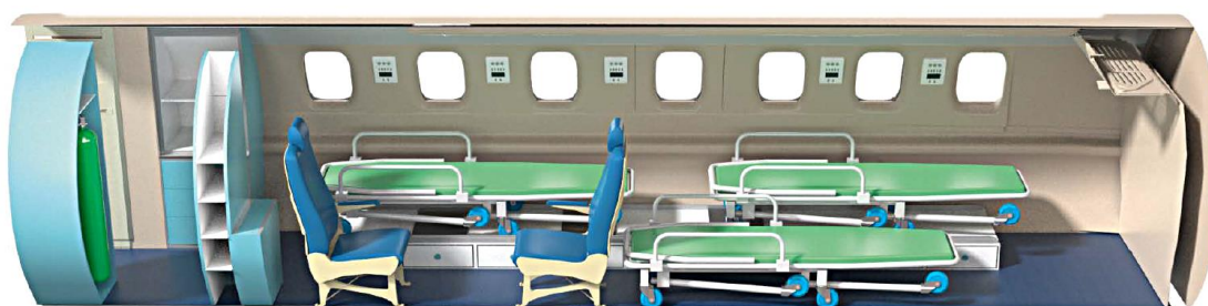
Obr. 29 Možná úprava kabiny letounu Pilatus PC-24
