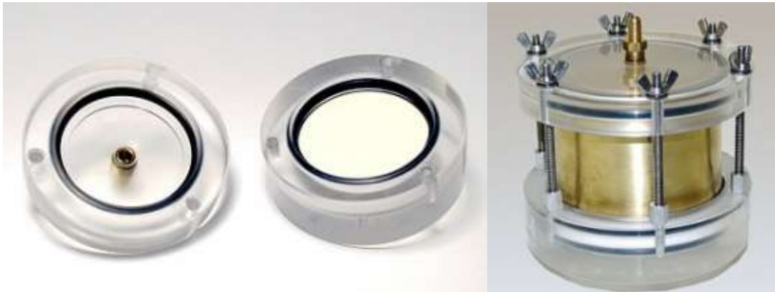
Obrázek 4 Tempská cela (ekotechnika.cz).
