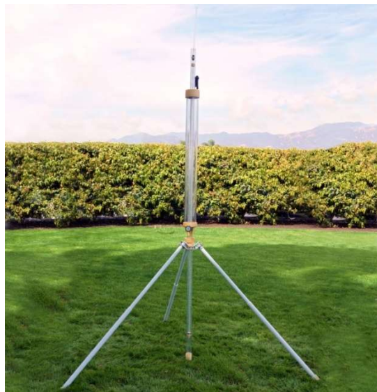
Obrázek 6 Guelphský permeametr (soilmoisture.com).
