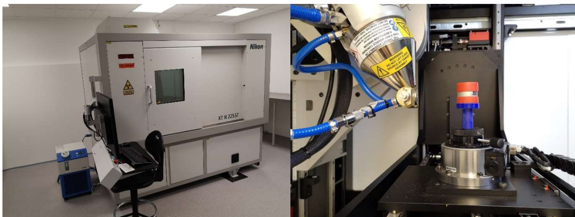
Obrázek 17 Průmyslový tomograf Nikon XT H 225 ST a vnitřní uspořádání tomografu (ilustrační snímek).
