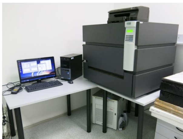
Obr. 15: Přístroj pro stanovení součinitele tepelné vodivosti Netzsch HFM 436 Lambda
