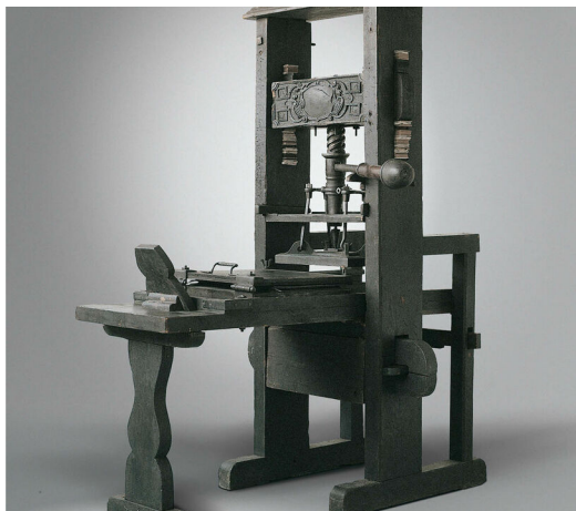
Obrázek 2.1: Dřevěný knihtiskový lis. Převzato z [5]
