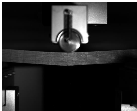
Příloha 3 - Průběh zkoušky pevnosti v ohybu při statickém zatížení (dub)
