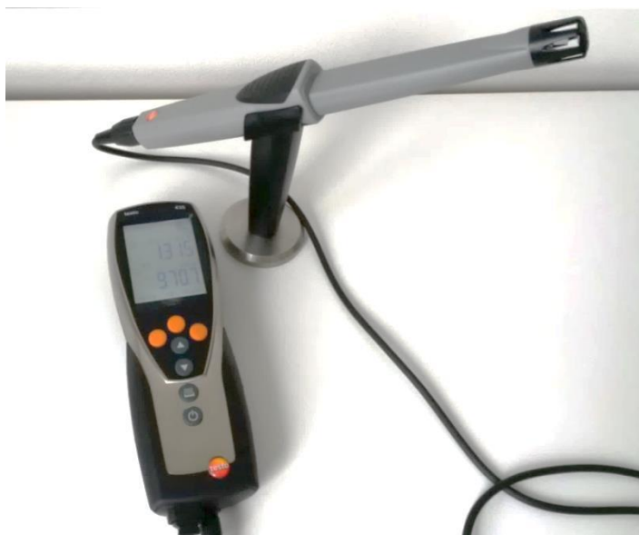
Obrázek 14 Měřicí přístroj testo 435 - 2 se sondou IAQ
