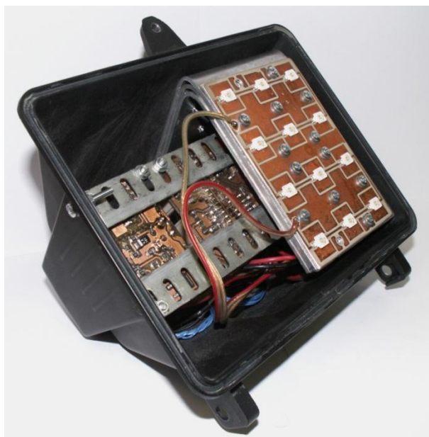
Obr. 39: Rozpracovaná instalace elektroniky do pouzdra 500 W reflektoru
