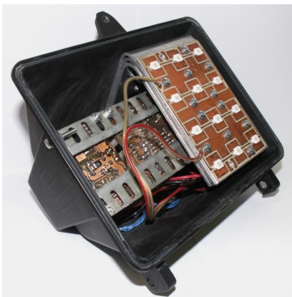
Obr. 39: Rozpracovaná instalace elektroniky do pouzdra 500 W reflektoru
