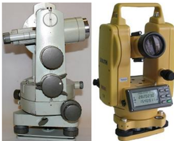
Obrázek 3.17: klasický teodolit Theo 010A, elektronický teodolit
