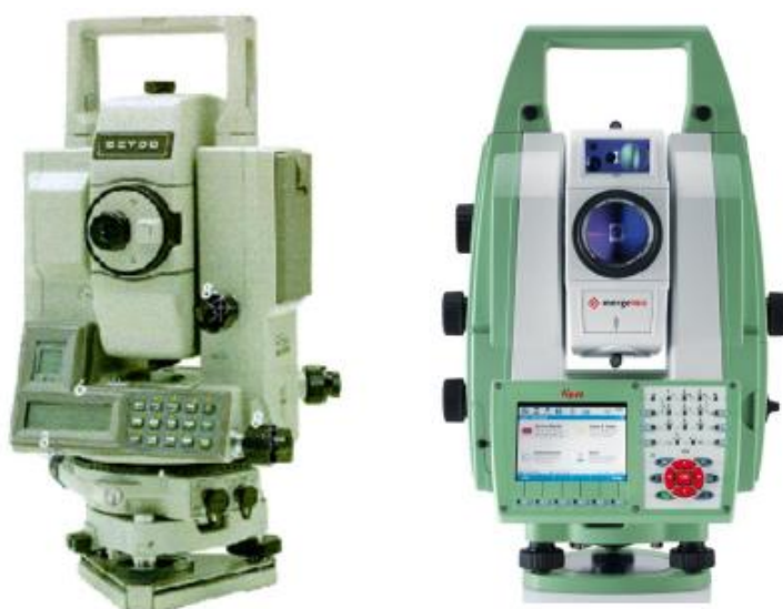
Obrázek 3.20: Vlevo starší typ totální stanice Sokkia SET 4B, vpravo novější typ totální stanice Leica Nova MS50 Multistation
