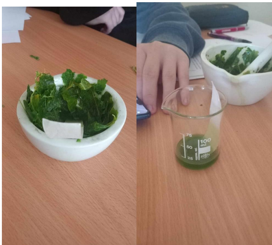
Obrázek 7 Příprava chlorofylu v třecí misce s tloučkem
