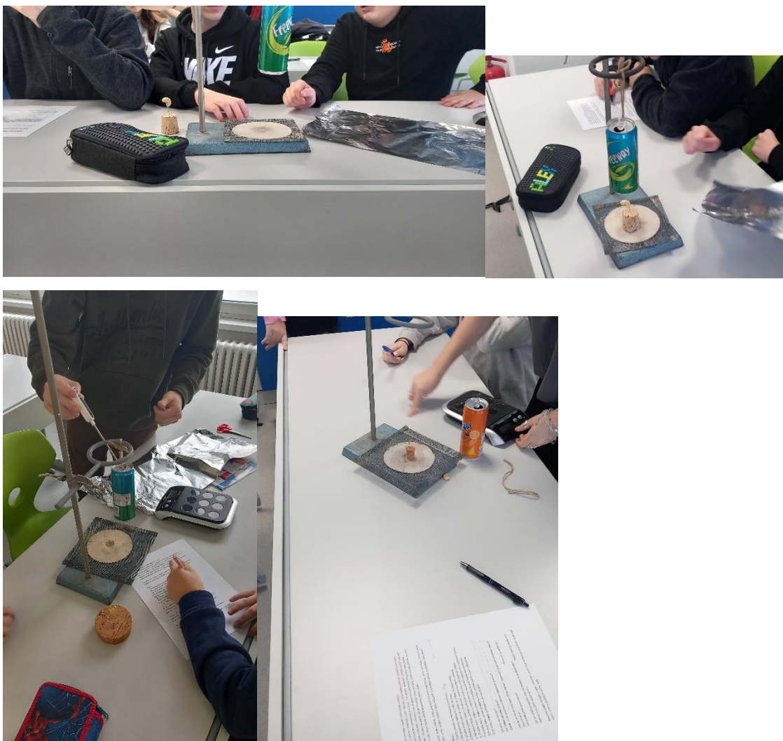
Obrázek 14 Průběh pokusu při spalování kešu oříšku
