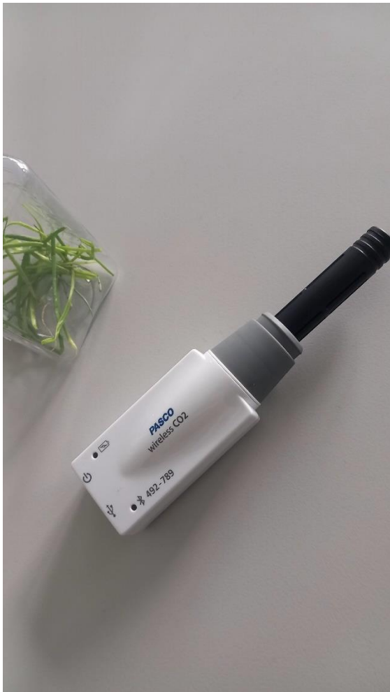
Obrázek 9 Přístroj PASCO pro měření koncentrace CO 2
