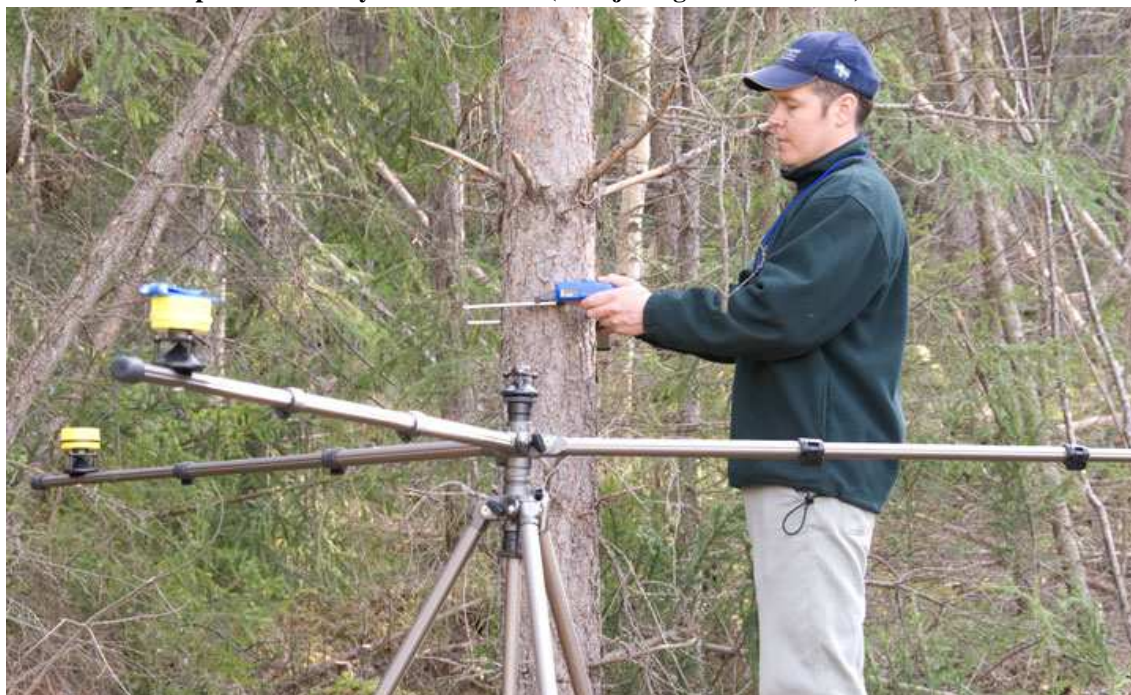
Obr. 30: Měření pozic stromů systémem Postex (Zdroj: Haglöf Sweden AB).
