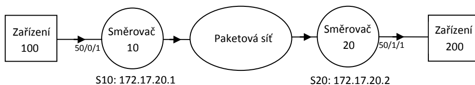
Obrázek 7.2 – schéma volání přes paketovou síť
