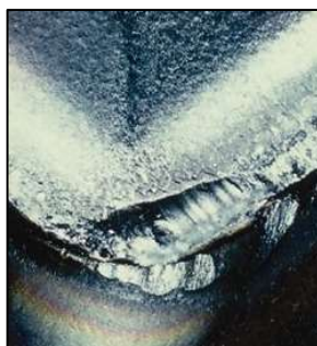
Obrázek 11: Opotřebení špičky nástroje [16]
