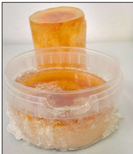
Obrázek 14: Spálené vzorky čisté pryskyřice
