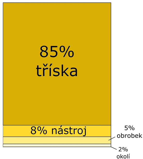
Obrázek 9: Tepelná bilance soustružení bez procesních kapalin
