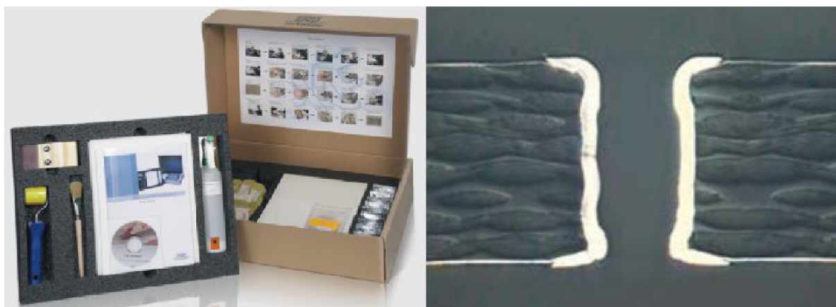
Obr. 5.7: Sada na realizaci prokovů vodivou pastou vlevo. Vpravo výbrus prokovu realizovaný vodivou pastou na vakuovém stole po vytvrzení vypékáním. [22]
