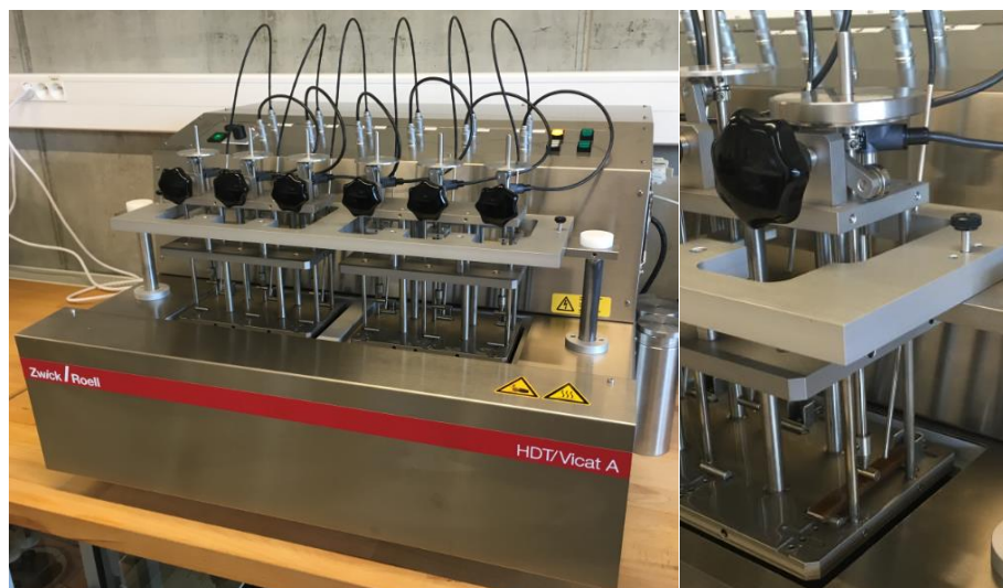
Obr. 3.20 Zkušební zařízení HDT/Vicat A od firmy Zwick/Roell (vlevo) a měření teploty průhybu při zatížení (vpravo)
