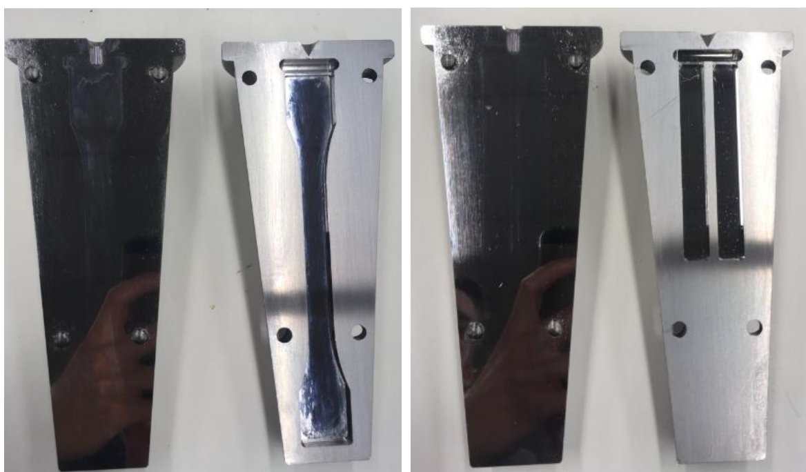
Obr. 3.8 Formy pro vstříkování zkušebních těles typu 1B (vlevo) a o rozměrech (80x10x4) mm (vpravo)
