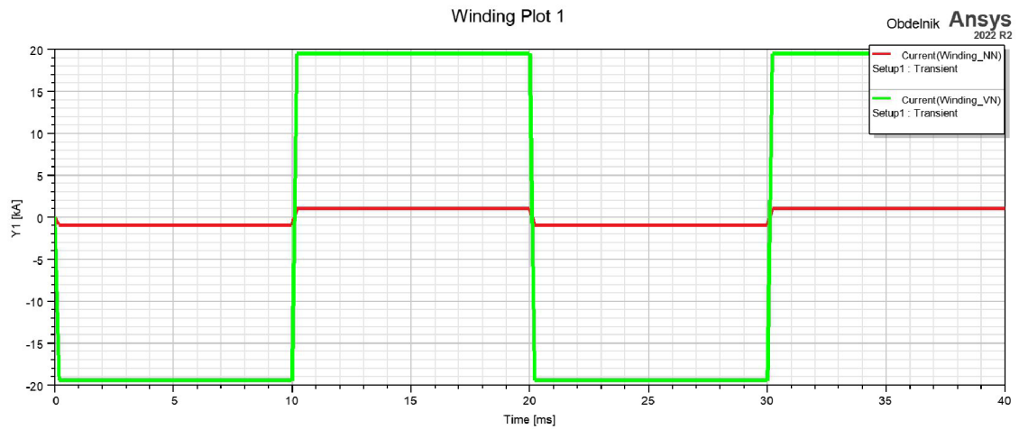
Obr. 3.4: Obdélníkový průběh proudu pro výkon 1000 kVA
