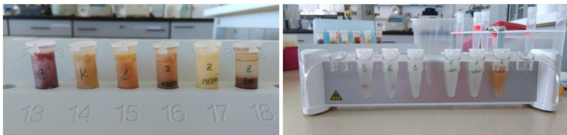
Obr. 9: Zľava: 0,5 g vzorky v 1 ml roztoku B; vzorky v magnetickom separátore
