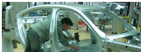
Obr. 14 Použití CMM ve firmě BMW [5]
