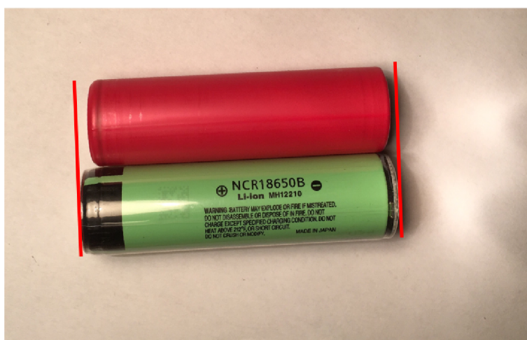
Obr. 1.9: Porovnání rozměrů baterie bez ochrany (červená) a s ochranu (zelená).
