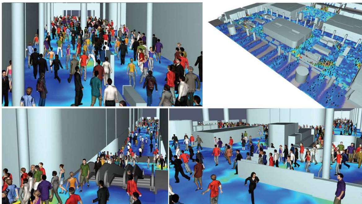
Obr. 6.1: Příklad bezpečnostní analýzy evakuace nádraží – detekce kritických míst, rozbor celého průběhu evakuace (zdroj: vlastní, ve spolupráci s [20] přepracováno)
