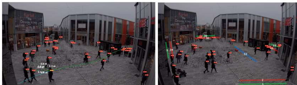
Obr. 3.8: Ukázka extrakce dat z videozáznamu pomocí DFS – detekce osob s id a jejich vzdálenosti vůči překážkám/osobám (vlevo) a aplikace profilového měření do extrakce dat z videozáznamu (vpravo) (zdroj: převzato od RCE Systems [220])
