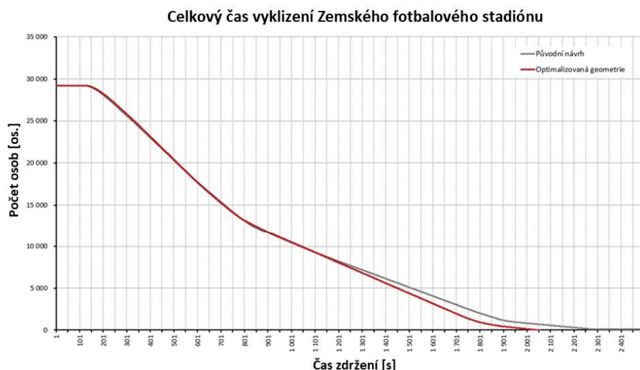
Obr. 5.60: Výsledné srovnání celkového času vyklizení původního návrhu bez aplikace změn (doba vyklizení 2 501 s) a optimalizované geometrie se zanesenými změnami (doba vyklizení 2 063 s) (zdroj: vlastní, ve spolupráci s [19])
