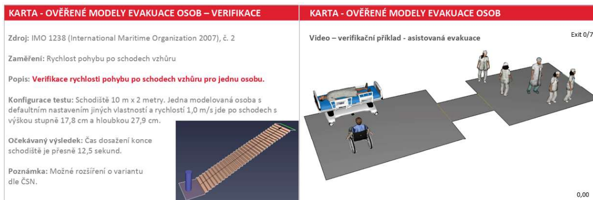
Obr. 4.24: Ukázka vzorové verifikační karty – zadání verifikačního příkladu (vlevo), výsledek verifikačního příkladu ve formě videa (vpravo), (zdroj: vlastní, ve spolupráci s [135])
