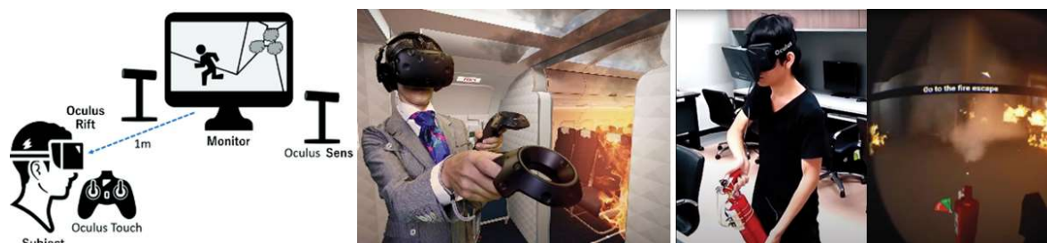
Obr. G.12: Schéma principu VR systém HMD (vlevo), příklad výcviku stevarda při simulaci požáru letadla (uprostřed), nácvik hašení požáru – figurant s headsetem vs. pohled do VR (vpravo) (zdroj: převzato z [543, 41, 541])
