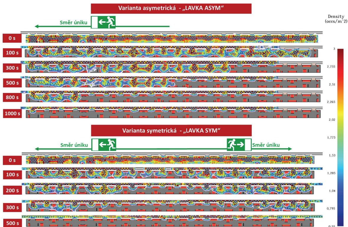
Obr. 5.28: Porovnání časového průběhu nouzové evakuace tunelu – varianta asymetrické evakuace „LAVKA ASYM“ (nahore) a varianta symetrické evakuace „LAVKA“ (dole) – rozdíly průměrných časů vyklizení mezi variantami jsou pro vlakovou soupravu 9,02 min (541,0 s) a pro celkové vyklizení tunelové části 11,48 min (689,7 s) (zdroj: vlastní, ve spolupráci s [24, 391])
