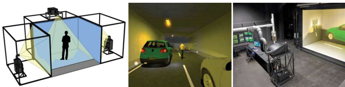
Obr. G.11: Schéma principu VR systém CAVE (vlevo), 3D multisenzorická laboratoř na univerzitě ve Würzburgu v Německu, systém CAVE (uprostřed), Screenshot simulace sociálních vlivu při evakuaci z tunelu realizované v systému CAVE (vpravo) (zdroj: převzato z [547, 380])
