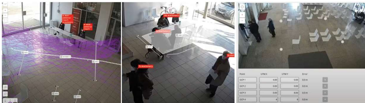
Obr. G.8: Ukázka videosekvence provozu vakcinačního centra na BVV analyzované v reálném čase pomocí z FLOW RCE – ID – trajektorie na zkoumaném koridoru (vlevo), vtyčení zájmových oblastí a označení ID vstupujících osob (střed), georeferencing obrazu (vpravo) (zdroj: vlastní ve spolupráci s RCE Systems)
