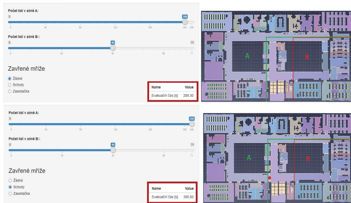
Obr. 5.54: Ukázka možnosti zpracování výsledků citlivostních analýz evakuace osob z posuzované budovy ve formě uživatelsky nastavitelné aplikace (zdroj: ve spolupráci s projektem TL02000103 )
