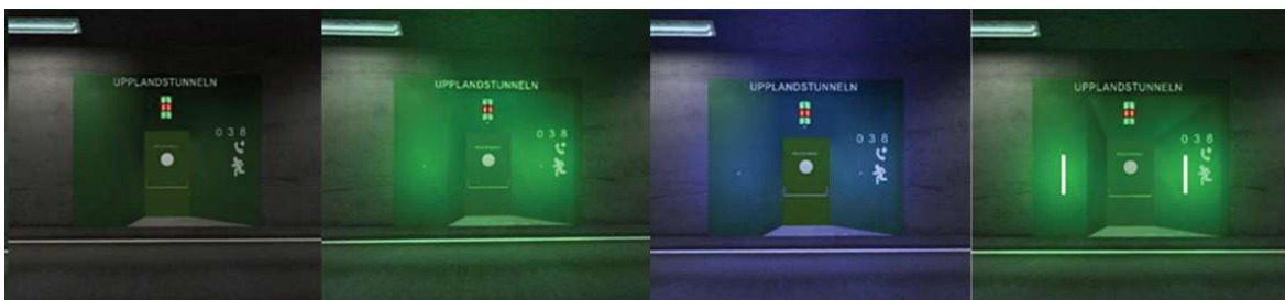
Obr. G.13: Příklad studie E. Ronchi et. al, testování osvětlení exitových portálů v tunelových stavbách (zdroj: převzato z [476])
