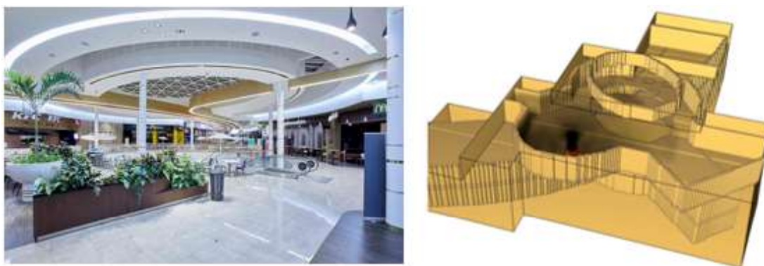
Obr. 4.18: Ukázka komplexní tvorby geometrie OC – interiér specifické stavby ve formátu .fbx (vlevo), příklad aproximace geometrie pro model požáru (vpravo) (zdroj: převzato z [21] a ve spolupráci s [21])
