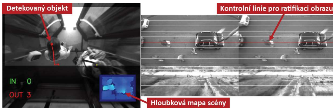
Obr. G.5: Příklady záběrů stereoskopického detekčního systému a rektifikovaného obrazu scény ze dvou kamer – vodorovné čáry kontrolních linií pro rektifikaci obrazu (vpravo) (zdroj: převzato a upraveno ze spolupráce s a [14])
