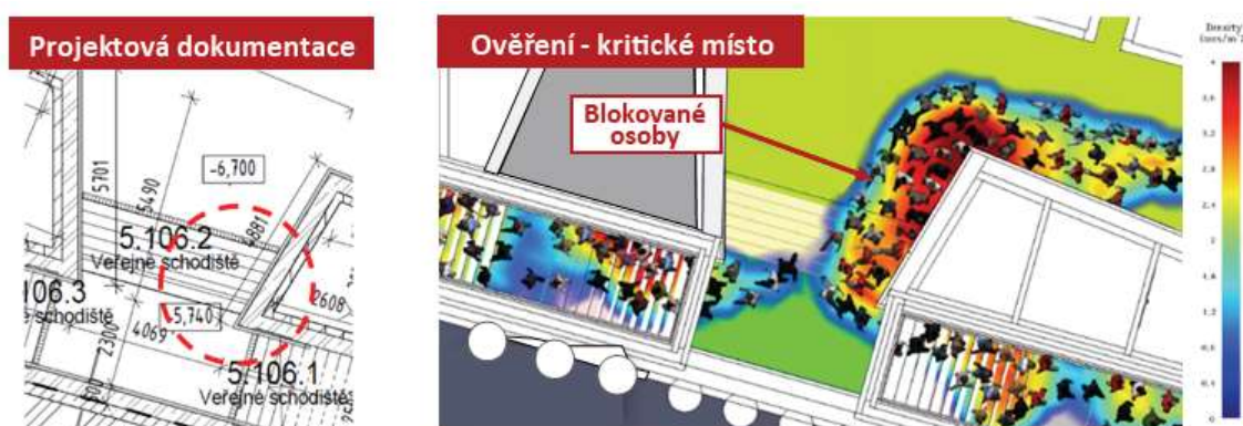
Obr. 5.69: Příklad kritického místa geometrie, kde kónický tvar ÚC způsobuje při úniku po schodišti odříznutí části evakuovaných osob masou okolních osob (zdroj: vlastní, ve spolupráci s [403] přepracováno)
