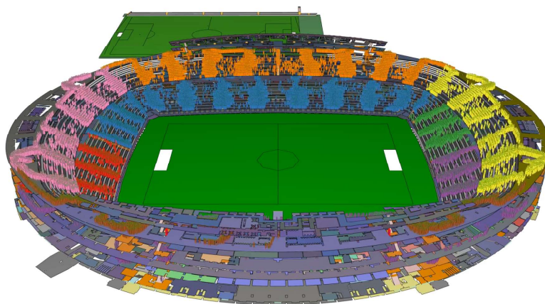
Obr. 3.4: Ukázka práce využití numerického modelu k posouzení evakuace osob ze Zemského stadionu Brno (zdroj: vlastní, ve spolupráci s [15])
