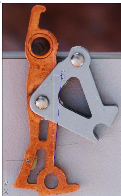
Obrázek 3.5) Fotografie vložena do CADu a odměřena úhlová odchylka od souřadného systému. Následoval krok obkreslení obrysů se všemi kružnicemi, zaobleními, kolnými hranami a podobně.
