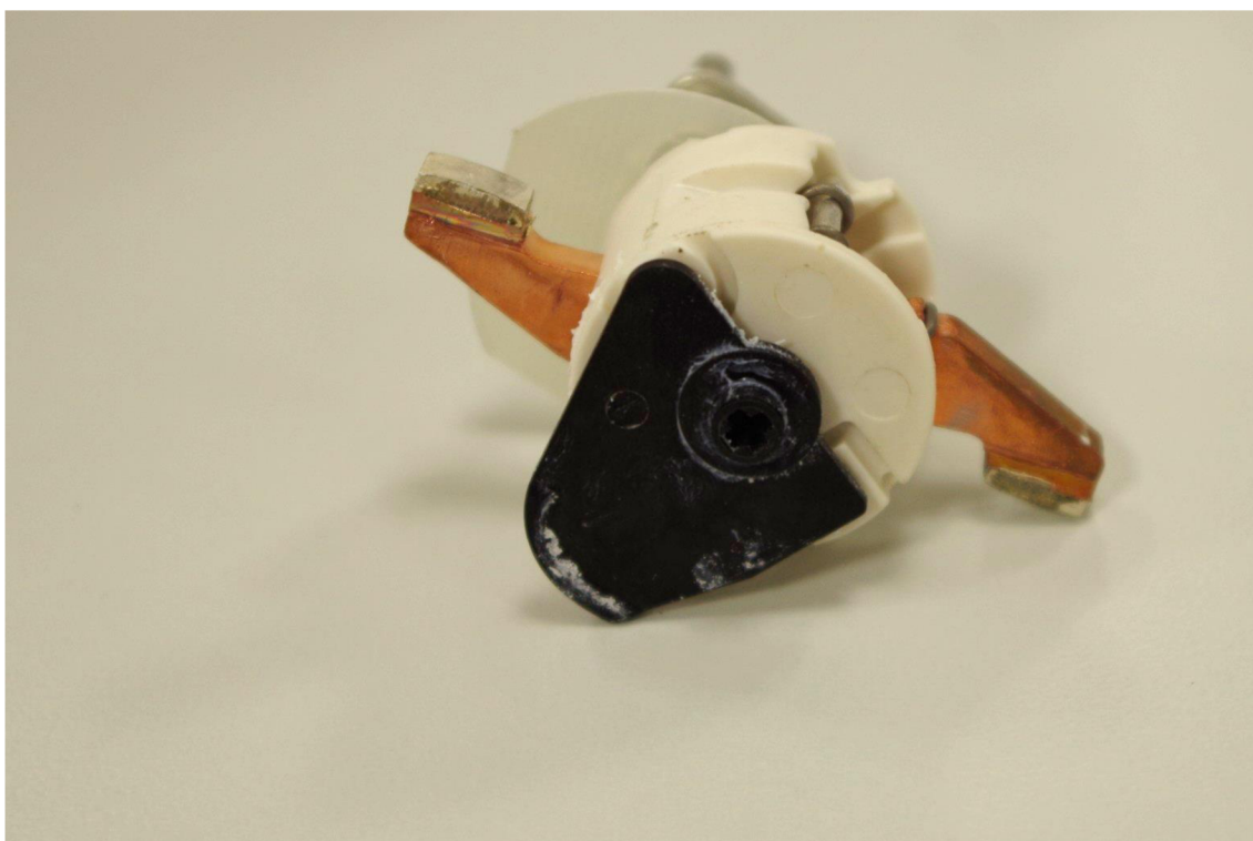
Obrázek 3.3) 1 pól rotoaktivní spouště.
