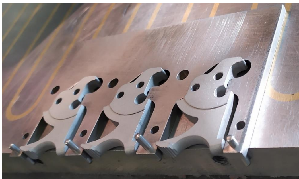
Obr. 25 Upnutí kohoutů k pracovnímu stolu rovinné brusky
