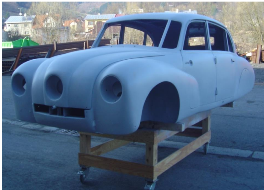
Obr. 6-18 Karoserie po vyvaření a základním nátěru
