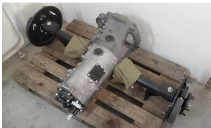
Obr. 6-19 Hotová zadní náprava včetně převodovky
