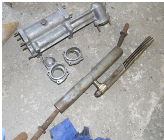
Obr. 6-13 Řízení v rozebraném a vyčištěném stavu
