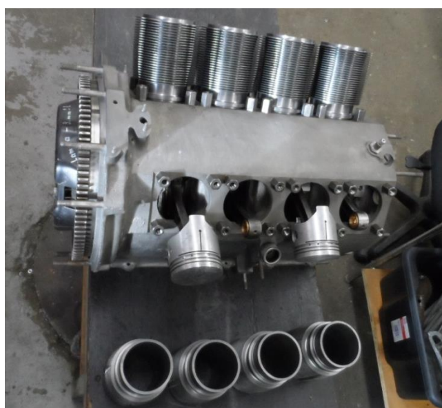
Obr. 6-8 Blok motoru ve fázi montáže
