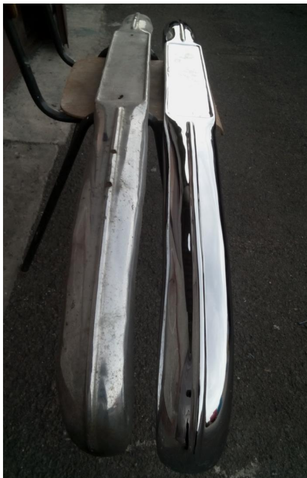
Obr. 6-15 Srovnání stavu nárazníků (vlevo před renovací/ vpravo po renovaci)
