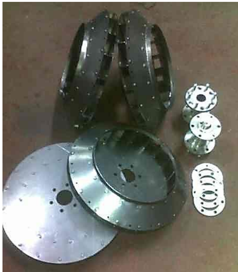
Obr. 6-6 Ventilátory pro chlazení motoru
