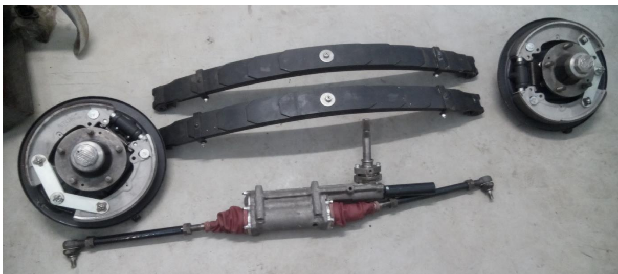
Obr. 6-21 Přední náprava po renovaci
