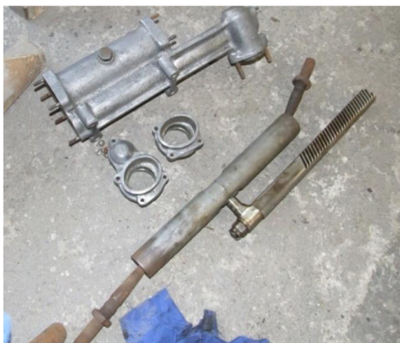
Obr. 6-13 Řízení v rozebraném a vyčištěném stavu
