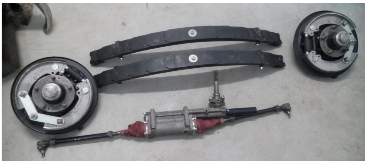
Obr. 6-21 Přední náprava po renovaci
