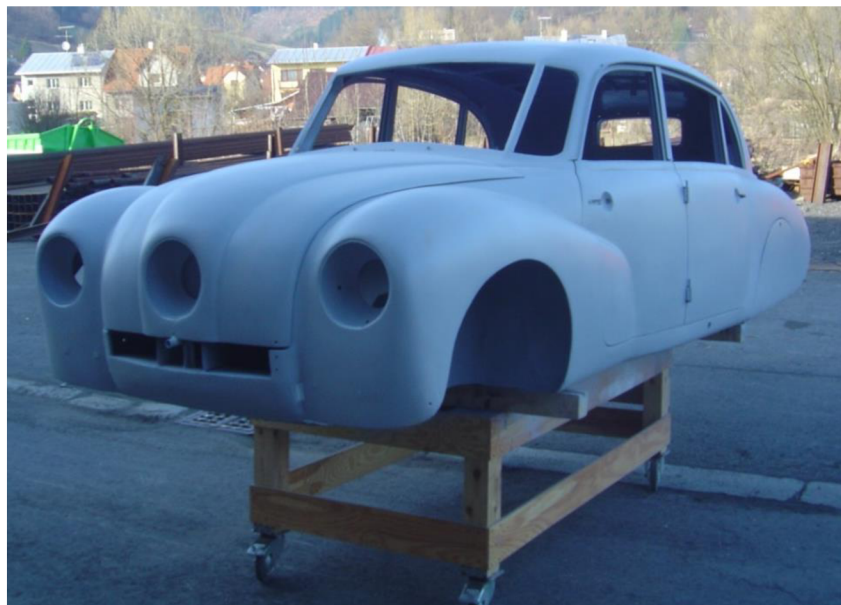
Obr. 6-18 Karoserie po vyvaření a základním nátěru
