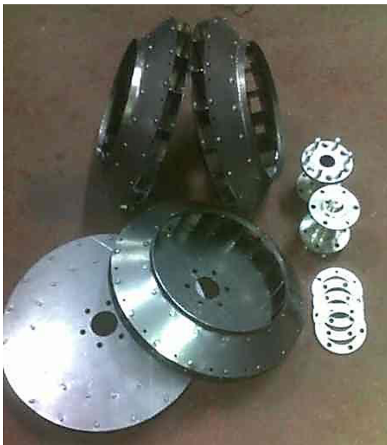
Obr. 6-6 Ventilátory pro chlazení motoru
