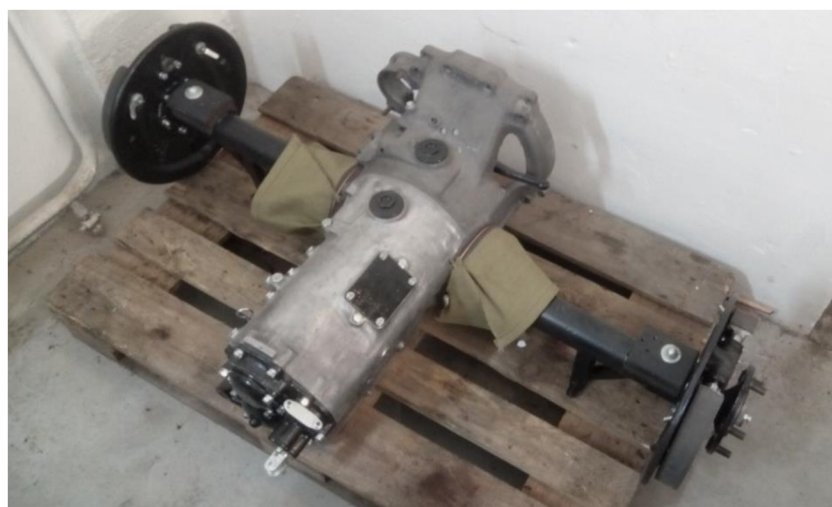
Obr. 6-19 Hotová zadní náprava včetně převodovky
