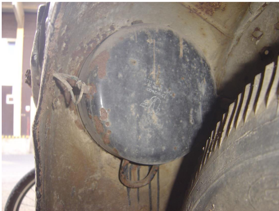
Obr. 6-10 Přivařený kuchyňský hrnec místo krytu světla
