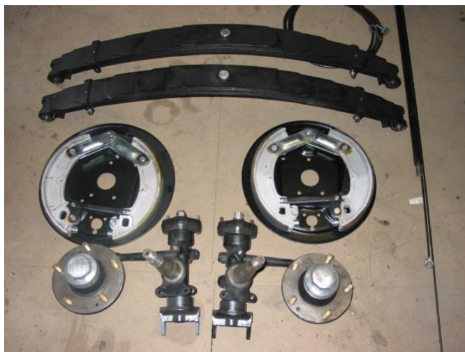
Obr. 6-14 Přední náprava v průběhu renovace
