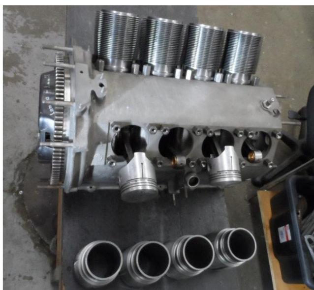
Obr. 6-8 Blok motoru ve fázi montáže
