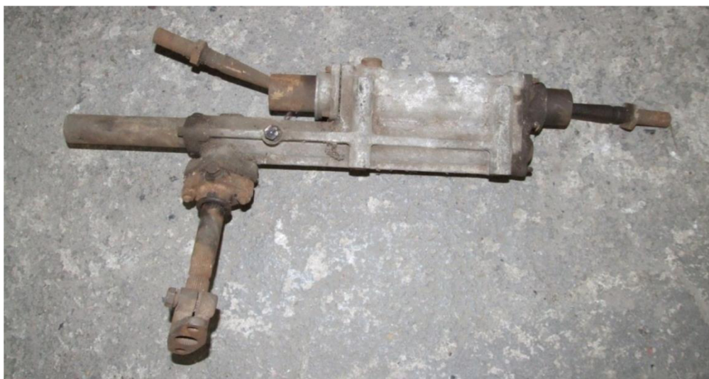
Obr. 6-5 Řízení po vytažení z vozidla
