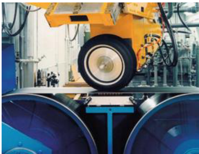
Obrázek 8: Stacionární testovací zařízení v Calspan's tire research facility, zdroj (Guiggiani, 2018)
