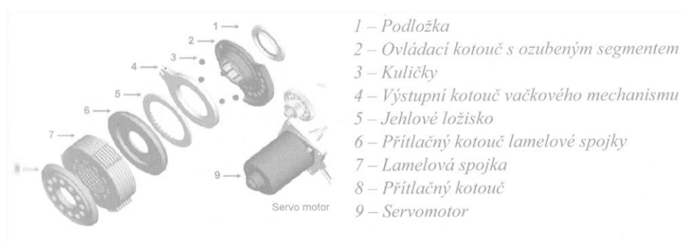
Obr. 12 Ovládání lamelové spojky diferenciálu ZF [4, s. 321]
