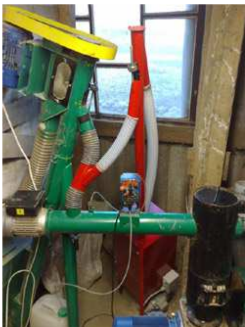
Obr.11. Dávkování suroviny do granulačního lisu
