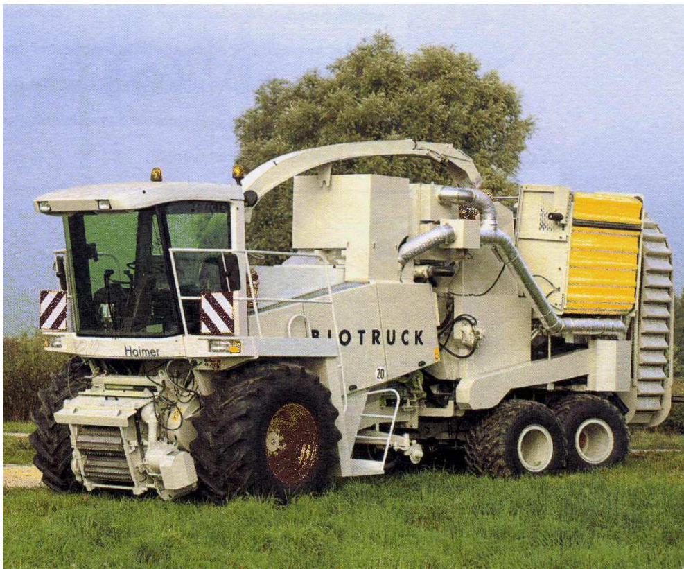
Obr.16. Mobilní granulační lis
