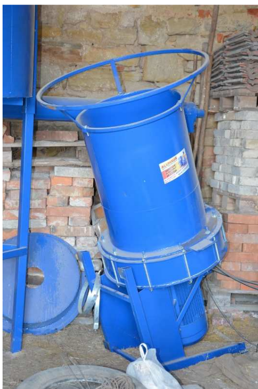
Obr.32. Celkový pohled na drtič MRS a pohled na předřezávací nůž
