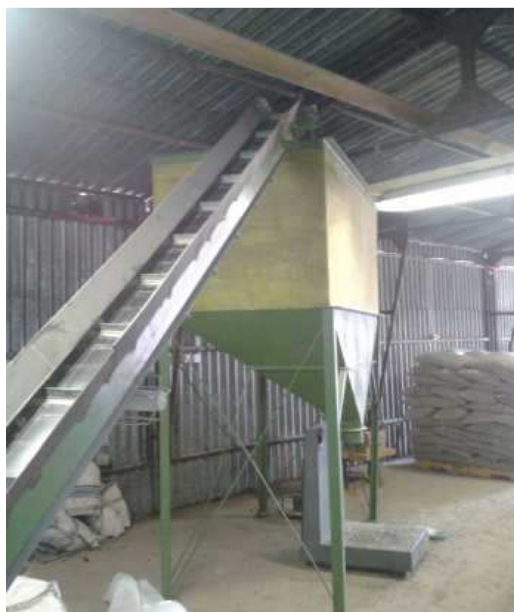
Obr.28. Pásový dopravník s příčkami a zásobník hotových pelet
