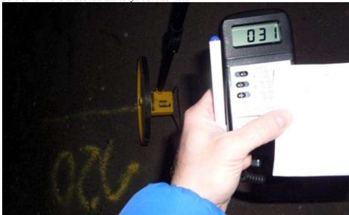
Obr. č. 40 Měření dosvitu dálkových světlometů
