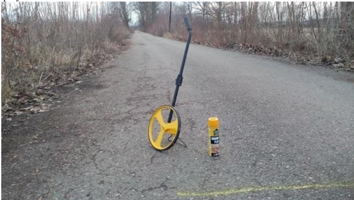
Obr. č. 38 Komunikace pro uskutečnění měření vzdálenosti, měřící kolečko, vyznačovací sprej
