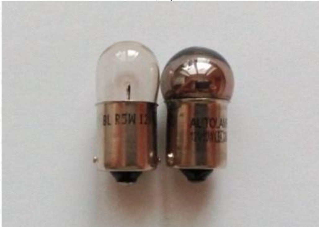
Obr. č. 4 Žárovka 5W 12V nalevo nová, napravo začernalá
