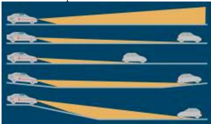
Obr. č. 32 Princip osvětlování komunikace
