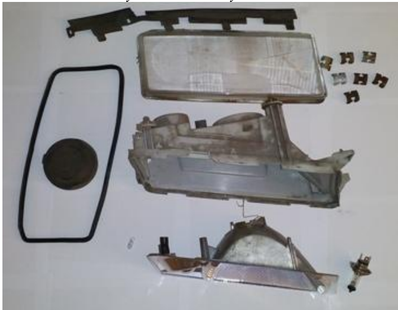
Obr. č. 22 Rozebraný světlomet Škody Octavia I
