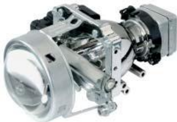
Obr. č. 31 Modul dynamického osvětlení systém (AFS)
