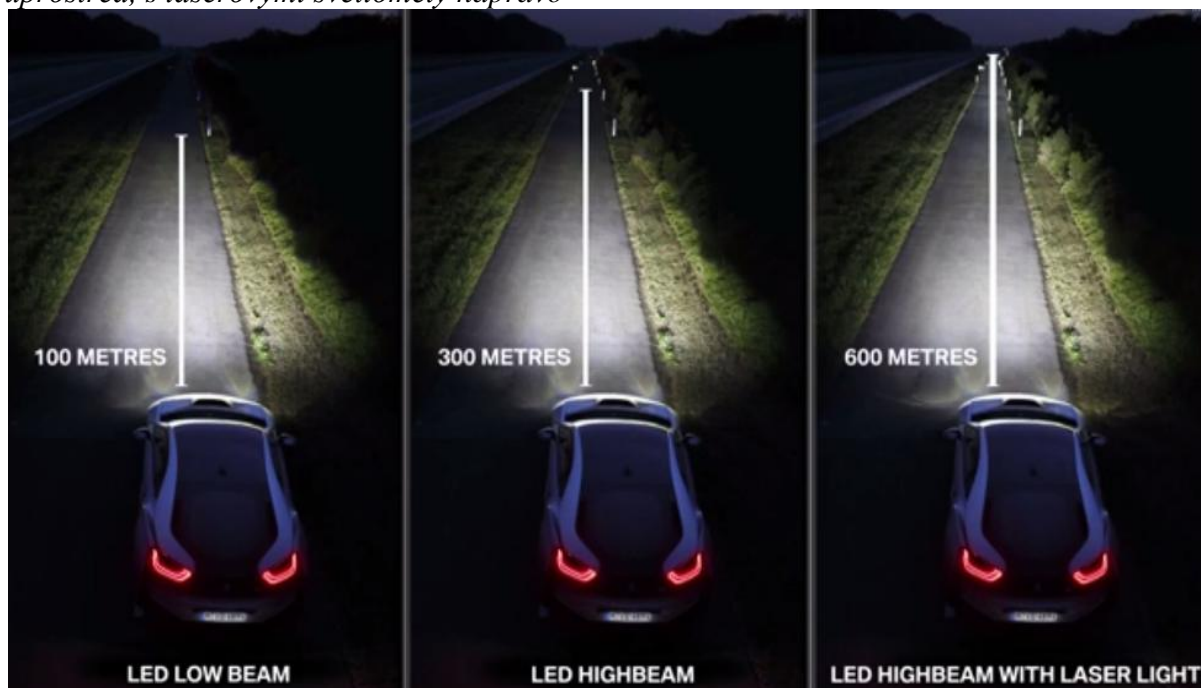
Obr. č.44 Porovnání LED dosvitu světlometů v potkávacím a dálkovém režimu nalevo a uprostřed, s laserovými světlometry napravo
