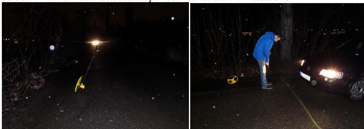
Obr. č.41 Měření vzdálenosti dosvitu pomocí Luxmetru u VW Passat 3B3
