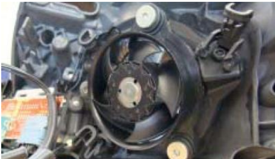
Obr. č. 21 Chlazení světlometu Audi A8
