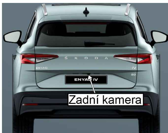
Obrázek 1.6: Pozice kamer na voze Enyaq iV – pohled zezadu [43]
