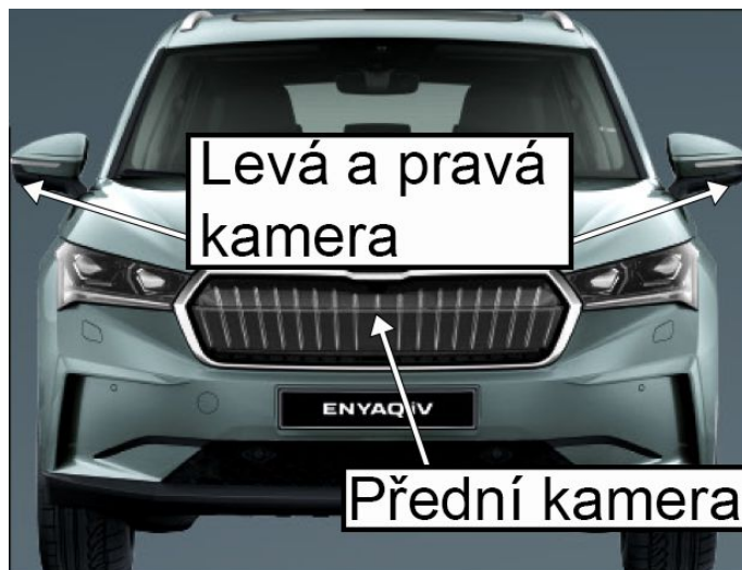
Obrázek 1.5: Pozice kamer na voze Enyaq iV – pohled zepředu [43]
