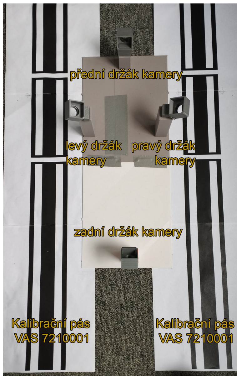
Obrázek 4.2: Testovací zástavba pro kalibraci kamer Enyaq iV – pohled shora
