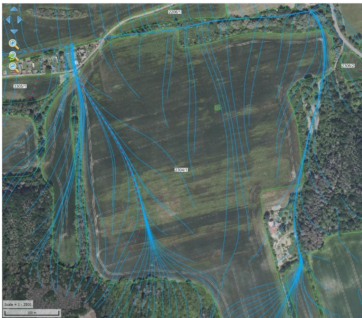
Obrázek č. 25: Odtokové linie vody na pozemku Pod Frajmankou, pořízený prostřednictvím aplikace LPIS (eAGRI, 2021).
