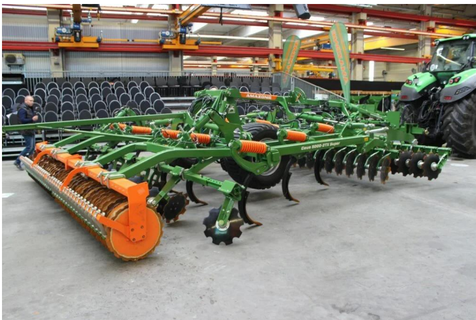
Obrázek č. 6: Kombinovaný kypřič Amazone Ceus (Mechanizace Zemědělství, 2017).
