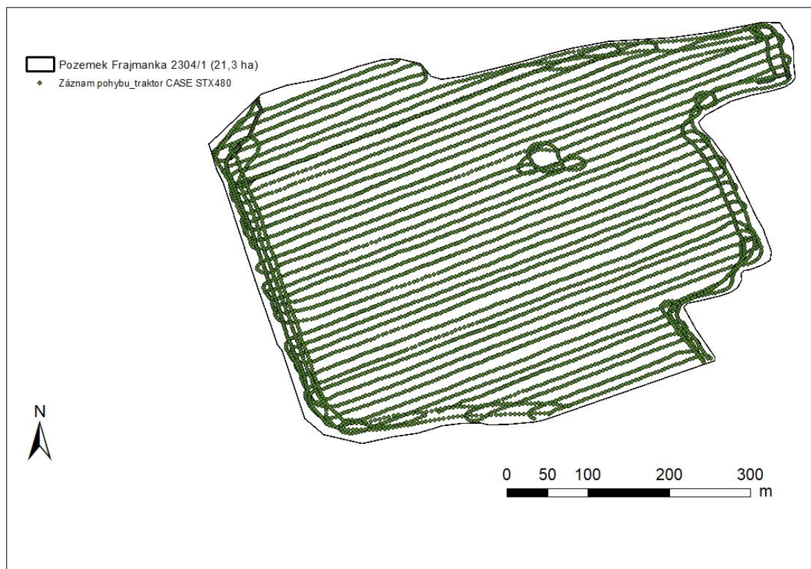
Obrázek č. 42: Mapa záznamu pohybu traktoru Case STX480, při provádění mělké podmítky.
