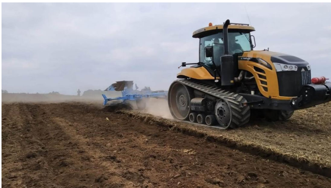
Obrázek č. 1: „On-land“ orba provedená pluhem Lemken Diamant (AgriMachines SE, 2020).
