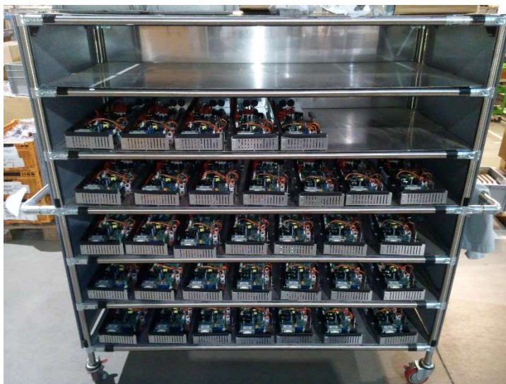
Obr. 4-3 Pojízdný regál pro uložení switchboxu [12]
