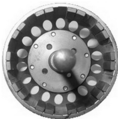
Obrázek 2.3: Rotor oběžného BLDC motoru.
