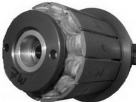
Obrázek 2.2: Statorové vinutí BLDC motoru.
