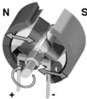
Obrázek 2.1: Principiální nákres stejnosměrného komutátorového motoru [16].
