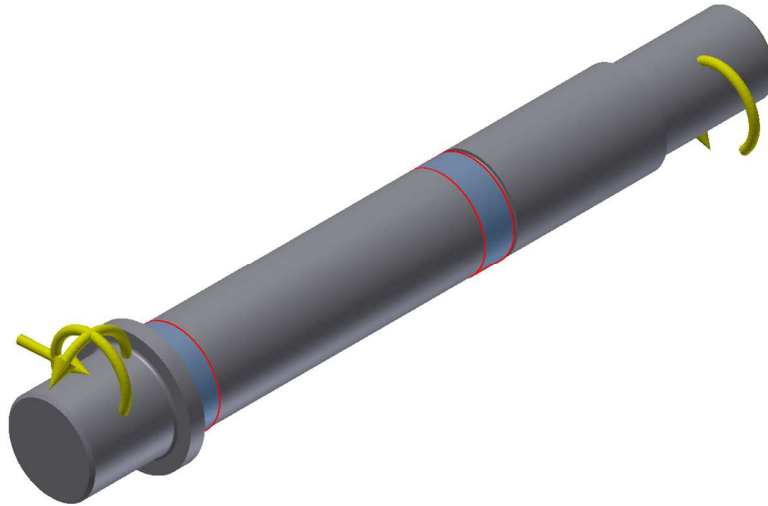
Obr. 25: Vymodelovaný vstupní hřídel s vyznačenými plochami pro zavedení okrajových podmínek.
