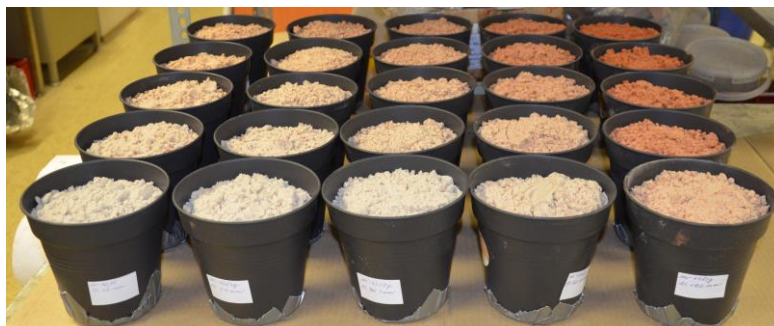
Obr. 25 Ukázka průběhu testu zadržování vody, experiment s pískem
