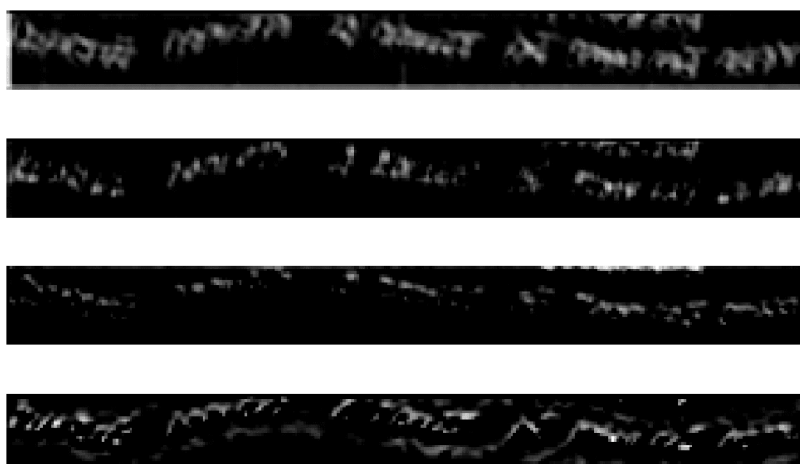
(a) Výstup ze čtyř kanálů poslední konvoluční vrstvy VGG2 s fixními váhami.
