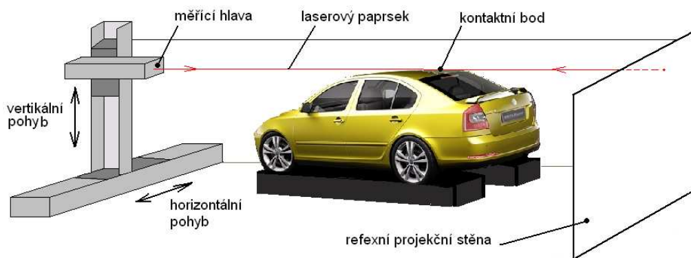
Obr. 1.22 Zjišťování čelní plochy pomocí laserového paprsku
