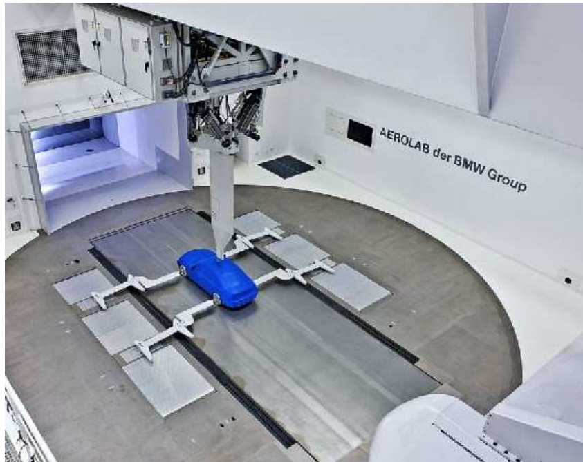
Obr. 1.29 Model vozidla v aerodynamickém tunelu [21]
