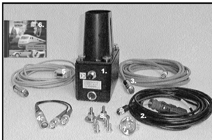
Obr. 3.4 Obsah balení Correvit L-CE, pozice: 1 – L-CE senzor, 2 - elektrický kabel, 3 -kabel pro přenos signálu, 4 – rozvaděč, 5 – CE_CAL komunikační kabel, 6 – CD se softwarem, 7 – Halogenová lampa 12 V, 20 W, 8 – montážní šrouby. [18]
