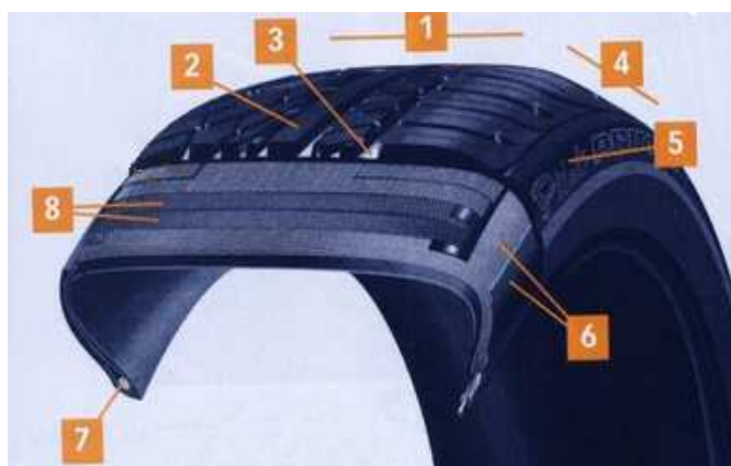
Obr. 1.2 Konstrukční prvky pneumatiky [8]
