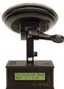
Obr. 3.7 XL Meter a jeho uchycení při měření na čelním skle vozidla [22]
