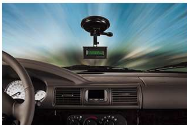
Obr. 3.7 XL Meter a jeho uchycení při měření na čelním skle vozidla [22]
