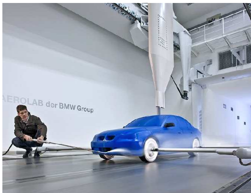
Obr. 1.28 Model vozidla s proudícím kouřovým proudem [21]
