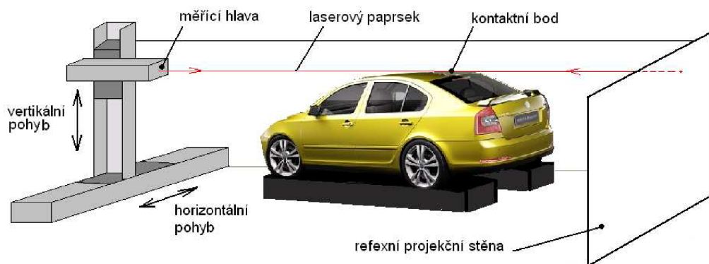
Obr. 1.22 Zjišťování čelní plochy pomocí laserového paprsku
