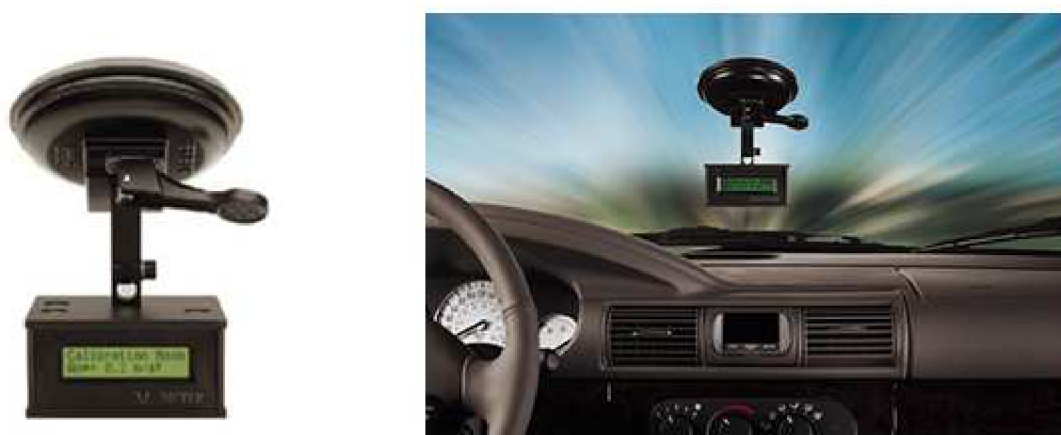
Obr. 3.7 XL Meter a jeho uchycení při měření na čelním skle vozidla [22]
