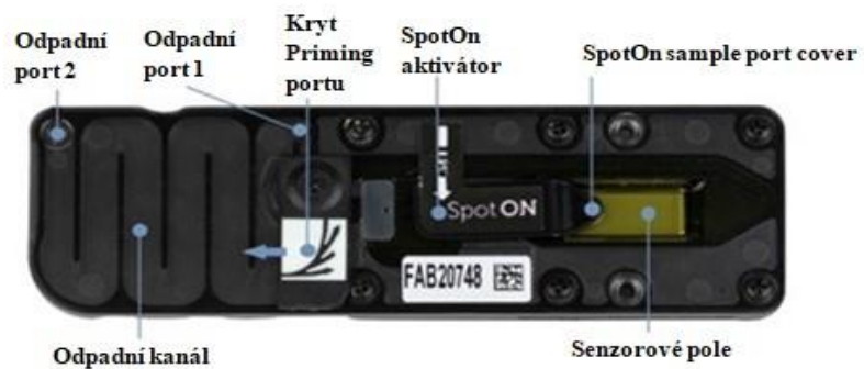
Obrázek 10: Části průtokové komůrky k sekvenátoru MinION. Převzato a upraveno z: Oxford Nanopore Technologies, 2022.
