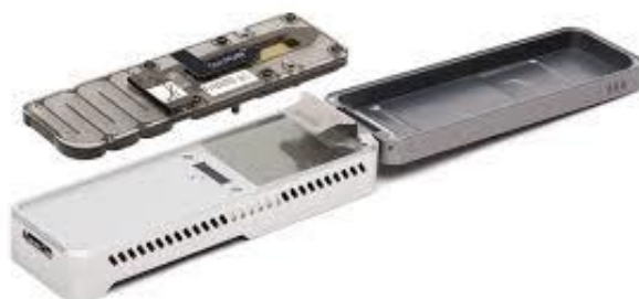
Obrázek 9: Vložení průtokové komůrky do sekvenátoru MinION. Převzato z: Oxford Nanopore Technologies, 2022.
