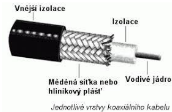
Obrázek 3 - Řez koaxiálním kabelem, zdroj: http://fyzmatik.pise.cz
