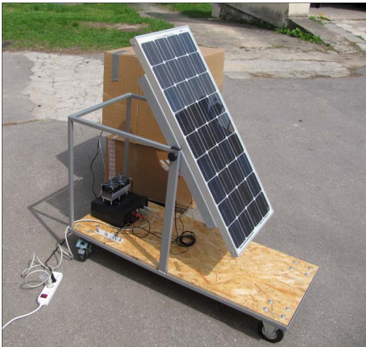
Obr. 23 Venkovní test modulu MPPL se zadaným FV panelem
