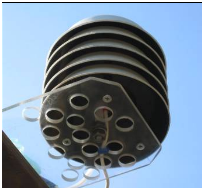
Obr. 7 Prototyp pasivního krytu snímače teploty vzduchu
