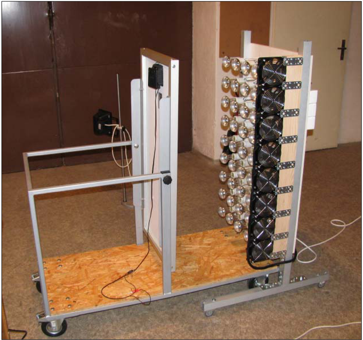
Obr. 24 Sestava testovací lampy a FV panelu
