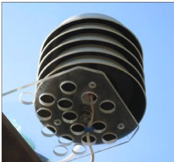
Obr. 7 Prototyp pasivního krytu snímače teploty vzduchu
